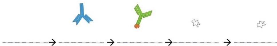
Kuva 2. kuvaa mitä vaiheita ELISA-menetelmässä tapahtuu, mikäli näytteessä ei ole läsnä koronaviruksen antigeeniä. Kuvassa sininen = primäärinen vasta-aine, vihreä = sekundaarinen vasta-aine, oranssi = entsyymi, valkoinen = lisätty substraatti
