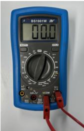
Kuva 1 Volttien mittaus yleismittarilla.
