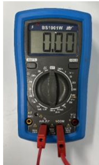
Kuva 2 Ampeereiden mittaus yleismittarilla.
