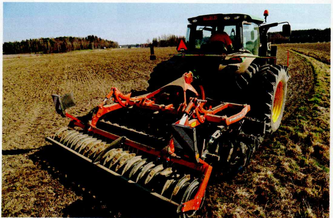
Kun takana on raskas nostolaitekone, joka päisteessä ja tiellä ajettaessa on ylhäällä, tarvitaan traktorin takarenkaisiin suuri rengaspaine. Muokatessa, kun kone on alhaalla, rengaspaine voi olla pienempi. Tällöin rengaspaineen muuttamisen peltopaineista tiepaineille pitää sujua nopeasti.
