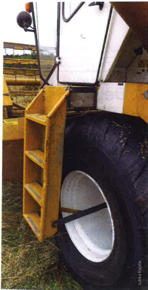
Matalaripainen matalapainerengas on varteenotettava vaihtoehto paremmaksi renkaaksi, jos pellot ovat tasaisia ja maan pinta kuivaa.
