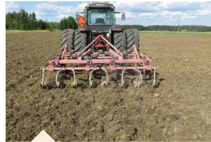
Kultivoinnilla siipiterin syvennetään muokattua kerrosta ja hienonnetaan kokkareita sekä läpileikataan maa katkoen kestorikkojen juuria. Lohkarainen rakenne on muuttunut muruiseksi pintakerroksessa.
