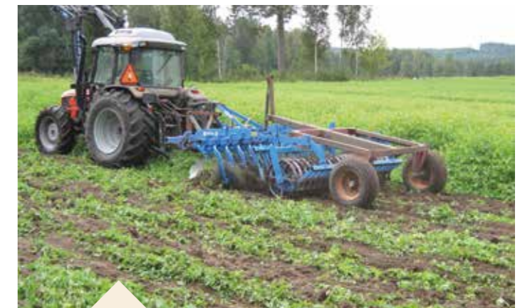
Veli Rahikainen muokkaa 1,5-metrinen vihantahernejälkeisen viherlannoituksen maahan raskaalla lautasäkeellä. Kaksi äestystä kevyellä kivennäismaalla on yleensä riittänyt. Lisämuokkauksia on tehty sen jälkeen kultivaattorilla muokkaussyvyyttä lisäten.
