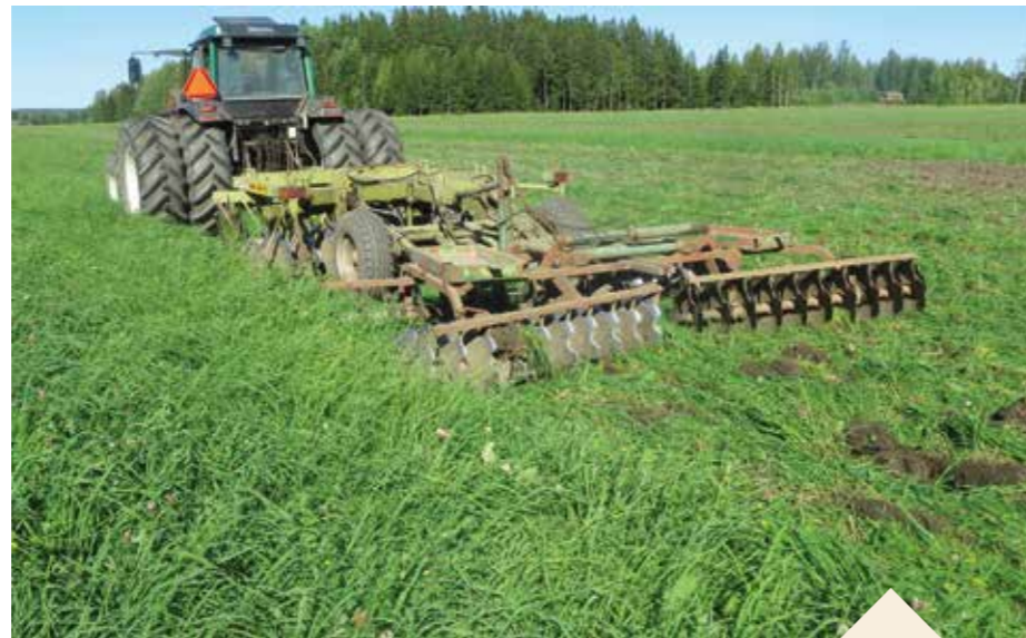
Kaksivuotisen viherlannoitusnurmen rikkomisen aloitetaan ajamalla raskaalla lautasäkeellä maan pinta rikki. Ensimmäisellä ajokerralla rikotaan maan pinta. Jälkiäkeenä on vanha kevyt lautasäes, joka rikko raskaan lautasäkeen irrottamia paakkuja. Tarvittaessa voidaan käyttää lisäpainoja kummassakin äkeessä.
