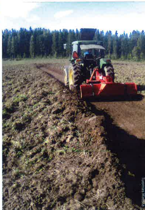
Maan siirtourasta pintamaat on kaavittu sivuun, tällöin siirrettävä maa pysyy tavallisessakin perälevyssä hyvin.
