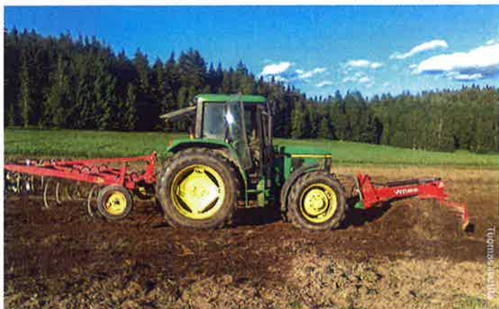
Kultivaattori takana ja perälevy edessä muodostavat hyvän pellontasausyhdistelmän.
