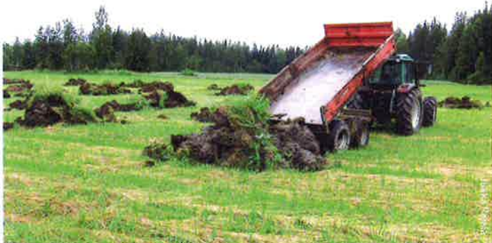
Maan siirtourasta pintamaat on kaavittu sivuun, tällöin siirrettävä maa pysyy tavallisessakin perälevyssä hyvin.
