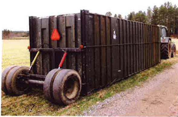
Välisäiliönä käytettävä merikontti on helppo siirtää traktorin avulla.
