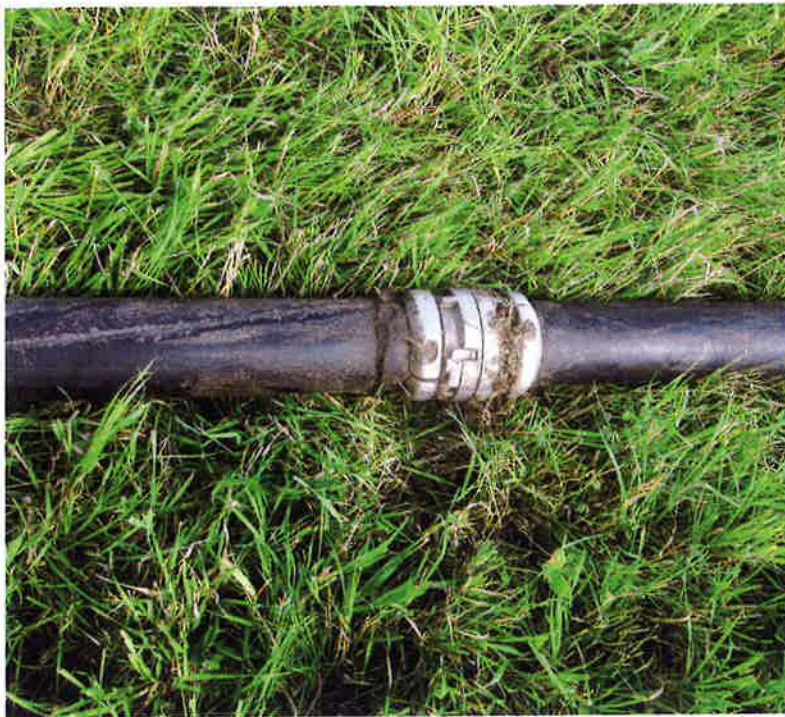
Letkut on nopea kytkeä yhteen pikaliitoksin.
