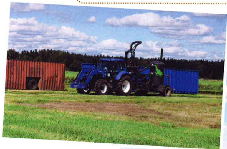
Välisäiliönä käytetään merikontteja, joista liete pumpataan tehokkaalla pumpulla letkua pitkin levittimeen.
