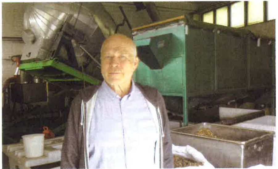
Biopallo-kompostointilaitoksen kehitysversion rummussa (takana) voidaan kompostoida kahden tonnin erä kerrallaan. Hajoamaton tukiaine voidaan seuloa kompostista pois uudelleenkäyttöä varten (vihreä laite oikealla), kertoo kehitystyötä tekevä Matti Saastamoinen.
