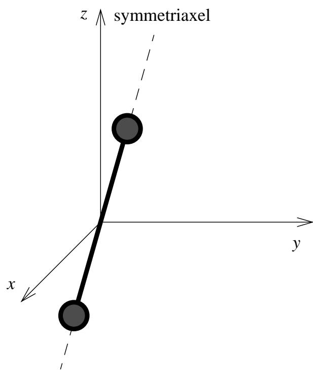
En diatomär molekyls orientering kan fastställas med hjälp av två vinkelvariabler som anger symmetriaxels riktning. Rotation kring symmetriaxeln kan inte iakttas!
