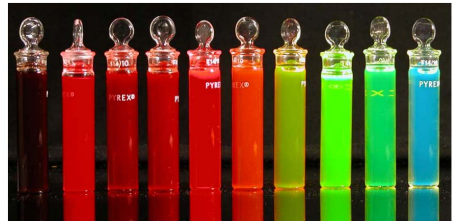
Fotoemission från olika stora CdSe/CdTe-nanopartiklar
